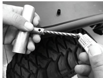
**3** Insérer l'alésoir dans la ponction. Faire circuler l'alésoir à travers la plaie perforante tout en tournant l'alésoir. Cela ouvrira légèrement le caoutchouc tout en repositionnant les courroies en acier pour faire de la place pour le bouchon.
