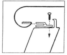
STEP TWO: LAY THE FRONT OF THE BRIEF OVER THE WINDSHIELD CHANNEL AND FOLD THE PLASTIC STRIP UNDER AND INSERT THE FRONT EDGE OF THE BRIEF INTO THE WINDSHIELD CHANNEL. PULL EACH END OF THE BRIEF UNTILL IT IS EVEN WITH THE WINDSHIELD CHANNEL.
