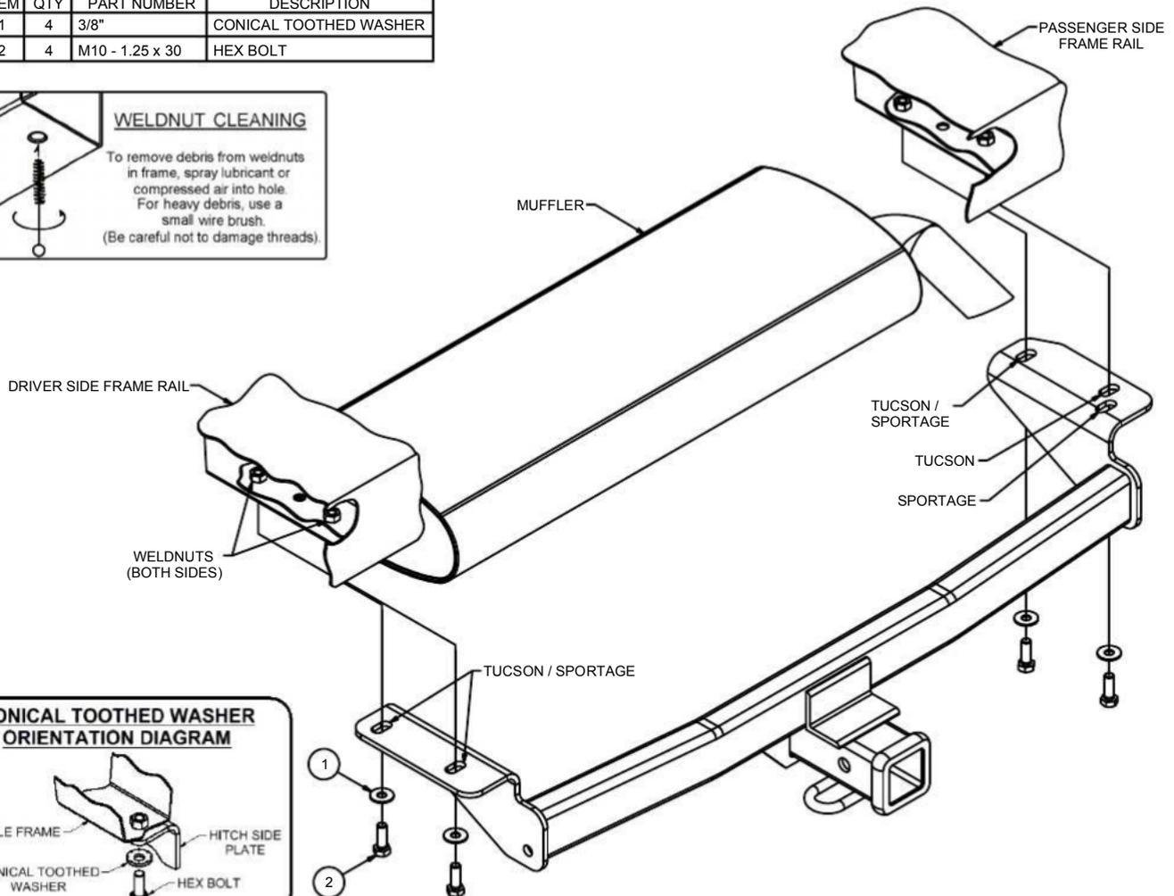
**CONICAL TOOTHED WASHER ORIENTATION DIAGRAM**
