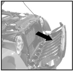
PULL GRILL FORWARD AND DOWNWARD TO UNHINGE THE SNAPS ALONG THE BOTTOM
