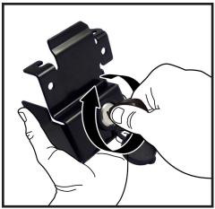
DO NOT PULL UP/DOWN ON KEY WHILE CODING WHILE MAINTAINING FULL KEY INSERTION, TURN THE KEY CLOCKWISE UNTIL IT STOPS - THE LOCK IS NOW CODED TO YOUR KEY!
